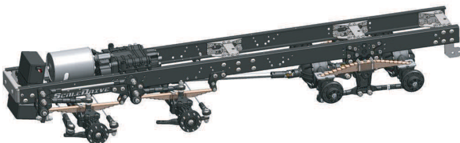
Fahrgestell 8x4 mit ScaleDRIVE Komponenten Variante 2
