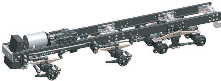
Fahrgestell 8x4 mit ScaleDRIVE Komponenten Variante 1
